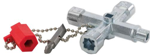
Universal-Schaltschrankschlüssel aus Zink-Druckguss. Für fast alle gängigen Schließungen geeignet. Drei Schließknöpfe haben eine Doppelfunktion. In der Mittelnarbe mit Heizungsentlüftungsschließung.
