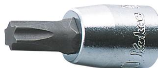
1/4" Steckschlüssel für Torx® T30 Schrauben mit Stirnlochbohrung. Die kurze Ausführung von 28 mm eignet sich besonders für das Anziehen von Schrauben bei engen Platzverhältnissen. Der Steckschlüssel ist für alle Hand-Steckschlüsselserien geeignet.
