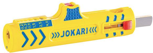
Entmanteler zum Abmanteln aller gängigen Rundkabel z.B. NYM 3 x 1,5 mm<sup>2</sup> bis 5 x 2,5 mm<sup>2</sup>. Die Titan-Nitrid beschichtete Klinge ist besonders robust.
