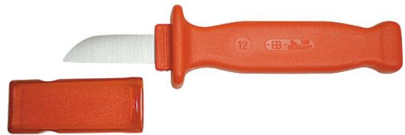
VDE-Messer mit 50 mm gerader, starker Klinge. Gesamtlänge 200 mm mit Klingenschutz. Griff aus zähelastischen, schlagfestem Kunststoff.
