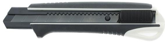
Der Kunststoff-Cutter mit 25 mm RAZAR BLACK-Klinge verfügt über einen 2-Komponenten-Griff. Mit Drucktastenmechanik und Metallklingenführung. Der Cutter ist mit einer Klinge bestückt, im Lieferumfang ist keine Ersatzklinge enthalten. Er ist besonders zum Öffnen von Kartons, Rillen von dicker Pappe und Abnehmen von Deckeldosen geeignet.
