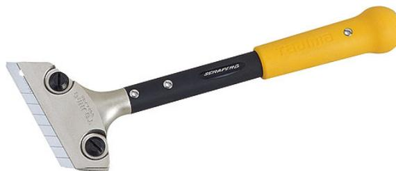
Der Uni-Schaber verfügt über einen Schaber-Kopf aus Aluminium-Guss und einen verstärkten Schaft. Er ist mit drei Klingen bestückt, die für spezielle Anwendungen umkehrbar sind und durch Knopfdruck gewechselt werden können. In Kombination mit einem Hammer ist der Schaber als Meissel-Werkzeug verwendbar. Für mehr Stabilität verfügt er über einen extra langen Griff.
