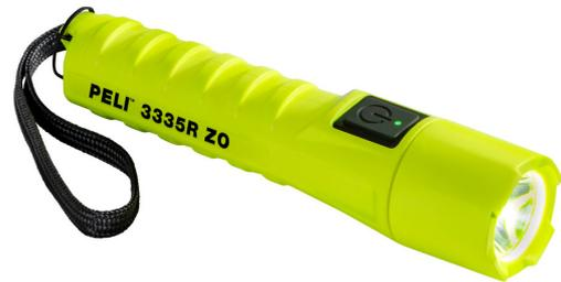
Wiederaufladbare Peli Taschenlampe nach Schutzklasse Zone 0 zum Einsatz in allen Bereichen, sogar dort wo Gase unmittelbar auftreten. Die 3335RZ0 mit einem kompakten Design, das bequem in der Hand liegt, verfügt über ein wasserdichtes, antistatisches und stoßfestes PC/PBT-Gehäuse nach IP67, das sich selbst in den anspruchsvollsten Arbeitsumgebungen bewährt. Die permanente Batteriestandsanzeige ist in den Netzschalter integriert, so dass Sie immer sehen, wann es Zeit ist, den Akku aufzuladen.
